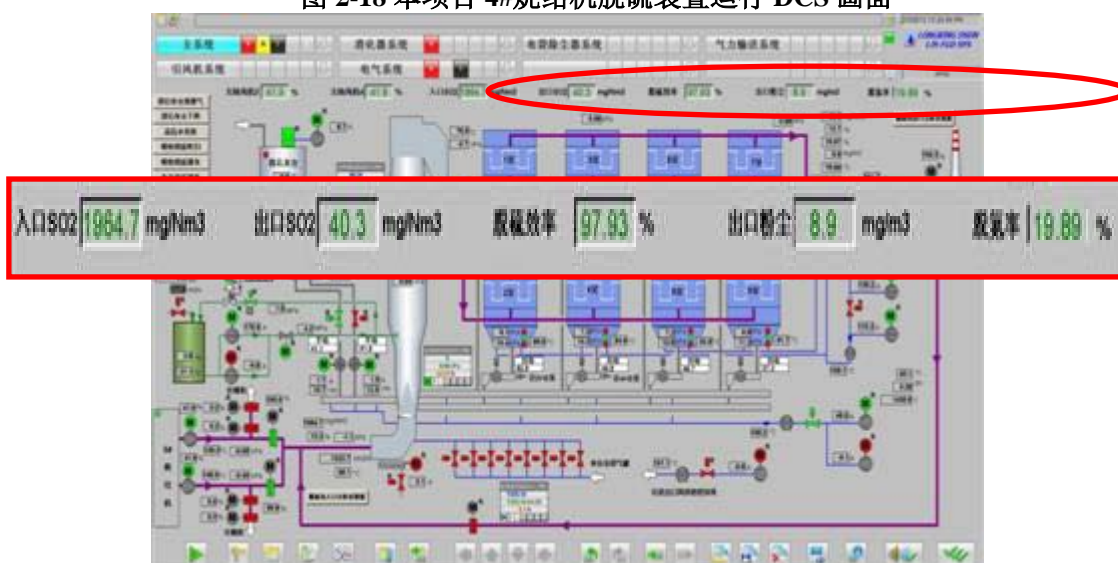
图 2-19 本项目 5#烧结机脱硫装置运行 DCS 画面
